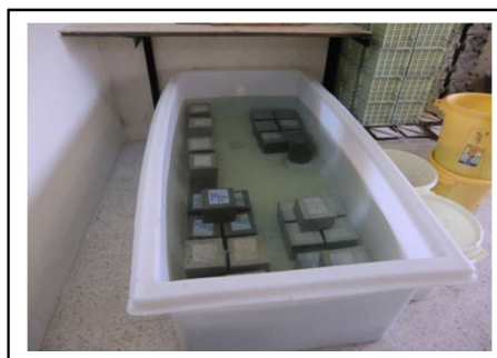
شکل ۶- نحوه نگهداری نمونه های بتنی در محیط آب معمولی
