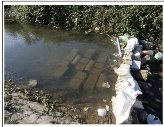
شکل ۷- نحوه نگهداری نمونه های بتنی در محیط واقعی (کانال آبیاری ولکس رشت)
