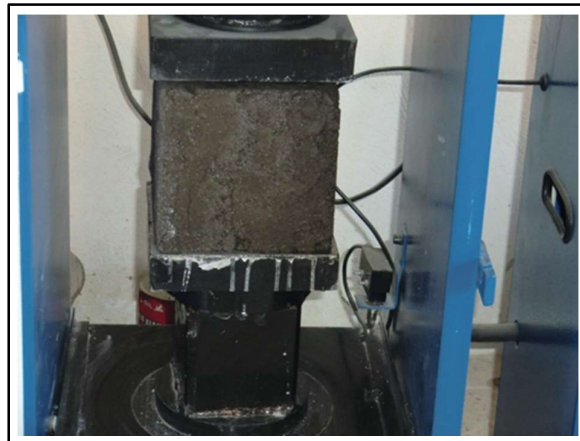
شکل ۸- نحوه ی شکست نمونه ها زیر جک فشاری
